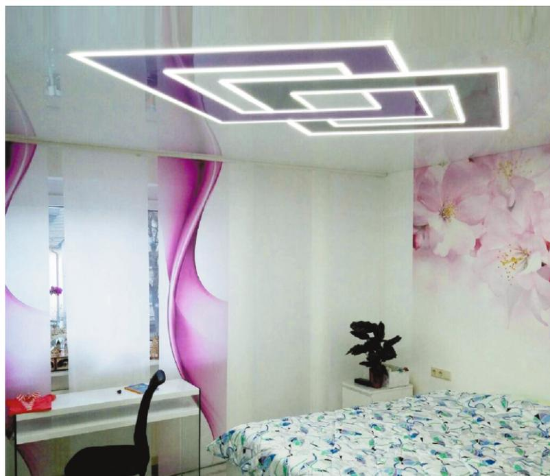
**pl** Profil do zainstalowania taśmy LED jest montowany na zawieszkach w taki sposób, aby podczas montażu pozostawać na poziomie podstawowego sufitu. Taśma jest montowana w specjalnym wpuście. Transformator montuje się na ścianie lub na suficie, najlepiej w dostępnym miejscu.
